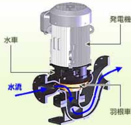
9kWマイクロ水車発電機
